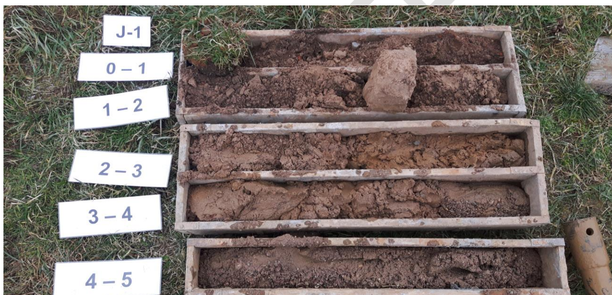
Obr. 2 Geologický profil vrtu J-1
