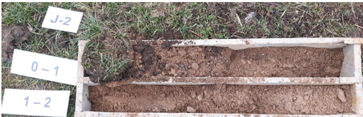
Obr. 4 Geologický profil vrtu J-2
