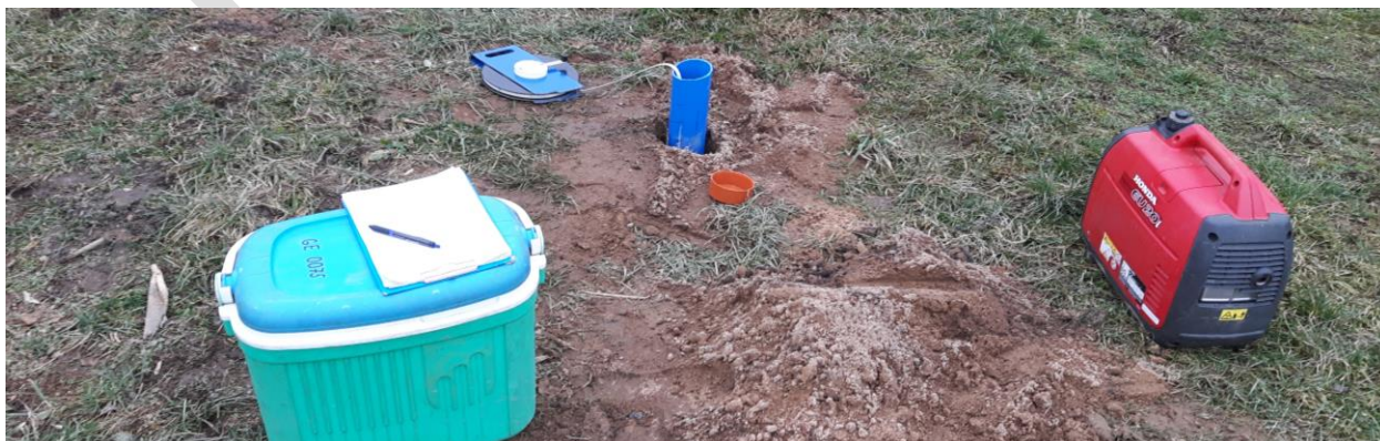
Obr. 11 Provádění vsakovací zkoušky ve vrtu J-4
